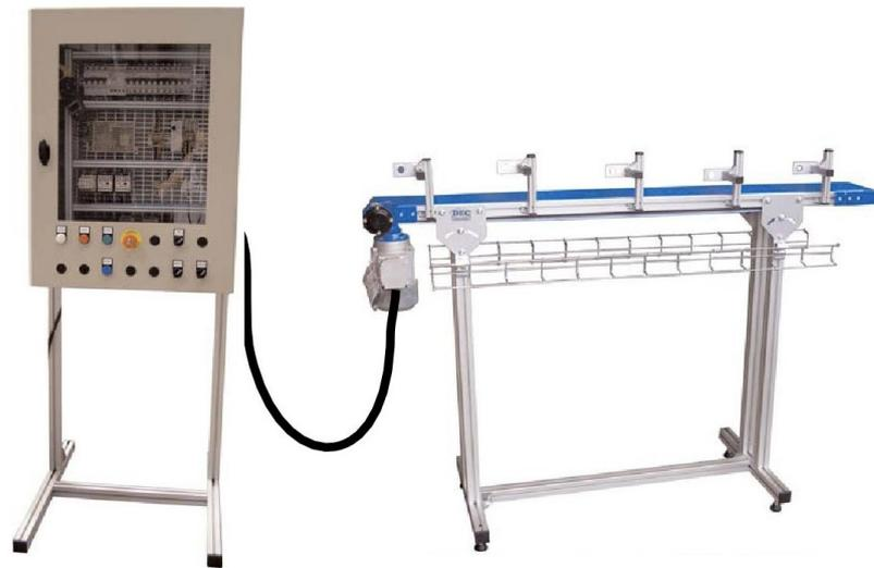
Le système industriel précédent sera remplacé par un tapis de convoyage équipé d'une ou plusieurs lampes pour simuler le système de chauffage, et d'un moteur (mono ou triphasé) simulant le ventilateur de trempe (voir figure suivante). Une sonde de température permettra de mesurer la température du four.
