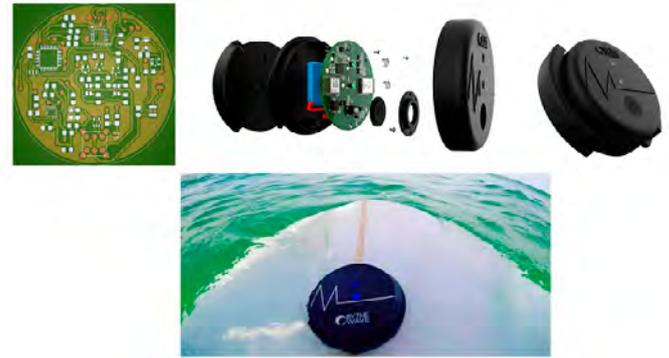
Figure 5 – Système d'assistance à la pratique du surf monté sur une planche (bas), carte électronique et boîtier conçus et assemblés par le TechnoShop (source images : <https://bythewave.surf/fr/>)
