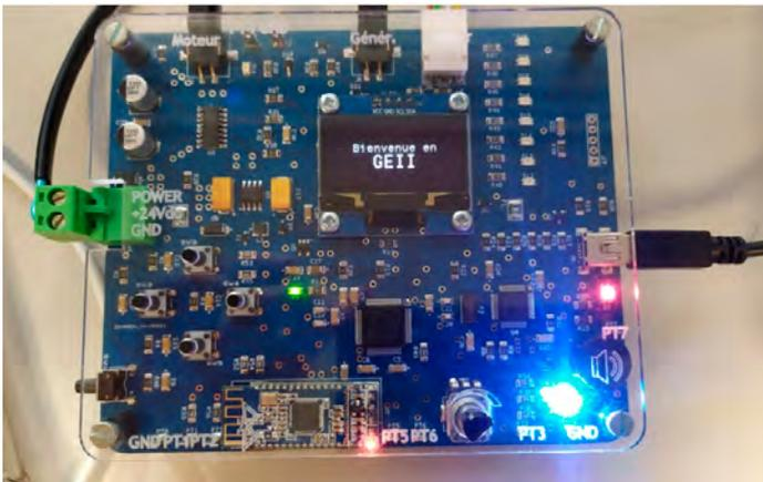
Figure 3 – Synoptique et photo de la carte, développée à l'IUT de Bordeaux, à base du microcontrôleur STM32F334R8, pour le pilotage du MCC (Source : Auteurs)
