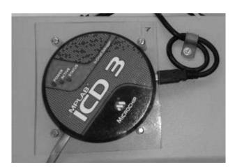
Figure 5 - Fixation et protection du chargeur/débogueur ICD 3
