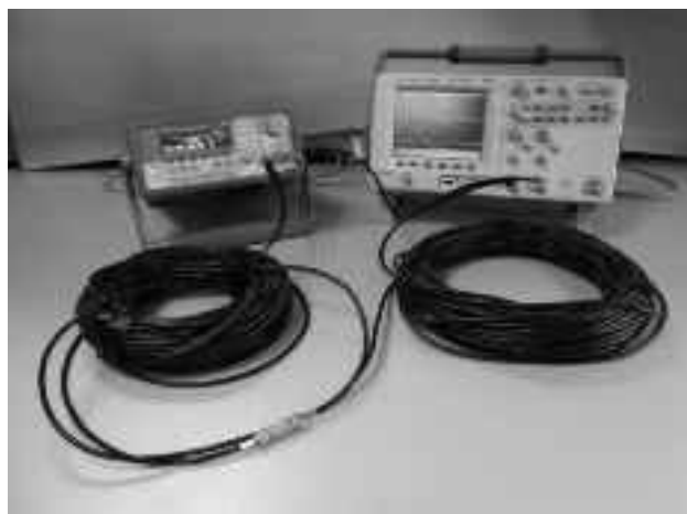
Figure 1 : Un générateur, un oscilloscope et deux rouleaux de câble coaxial de 50 m chacun
